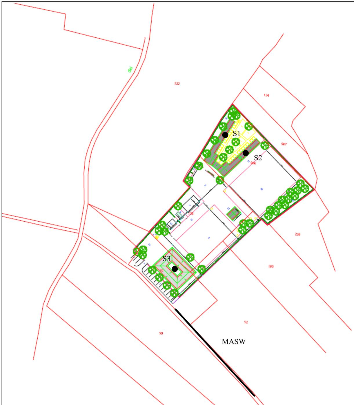
Ubicazione dei sondaggi S1-S2-S3 e della sismica a rifrazione superficiale tipo MASW.
